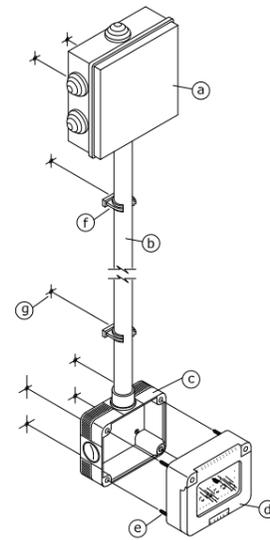
PUNTO DI COMANDO/PRESA CON SCATOLA PORTAFRUTTI DA ESTERNO DOTATO DI SPORTELLINO MEMBRANATO IP55, TUBAZIONE IN PVC RIGIDO E CASSETTA DI DERIVAZIONE DA ESTERNO.
