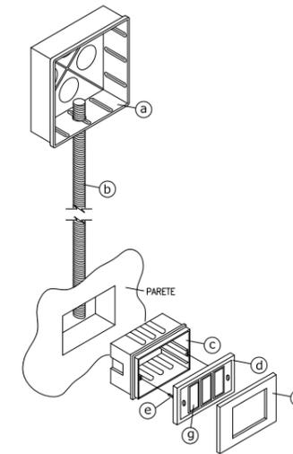
PUNTO DI COMANDO/PRESA CON SCATOLA PORTAFRUTTI DA INCASSO, TELAIO DI SUPPORTO, PLACCA, TUBAZIONI IN PVC CORRUGATE E CASSETTA DI DERIVAZIONE AD INCASSO.
